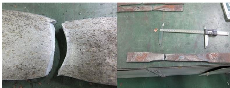
図-3.1.4 鋼材の引張試験の状況
