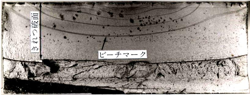
図-3.1.40 継手試験体の溶接止端部から発生した亀裂の進展状況<sup>3.3)</sup>
