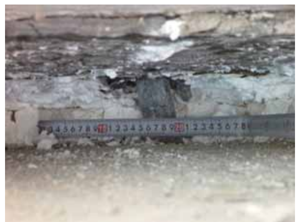
(b) アンカーバーの変形 (22mm)
