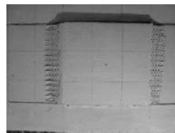
写真-4 押し抜き試験状況 （目地部）
