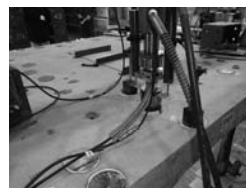
写真-3 押し抜き試験状況
