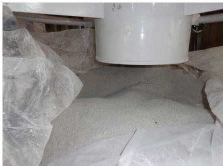
写真 2-8 フレコンに投入した乾燥 MAP の例
