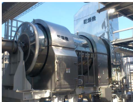
写真 2-7 MAP 乾燥装置の例
