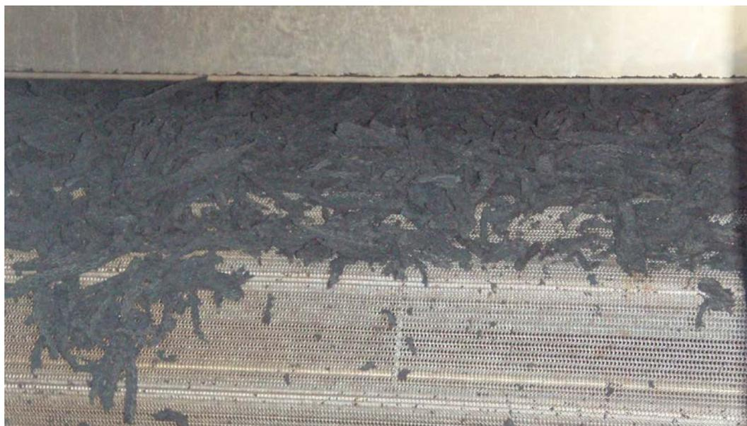
写真 2-3 2 段目以降の乾燥汚泥の移送状況
