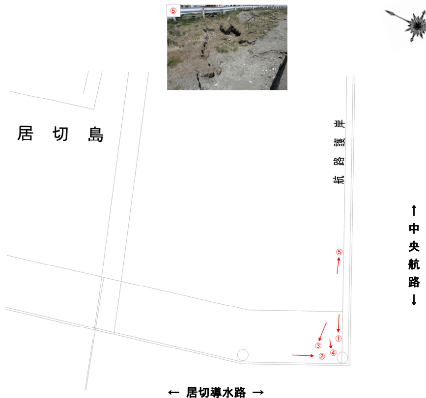
図-A.16.15 No.1 北側護岸の被災状況平面図
