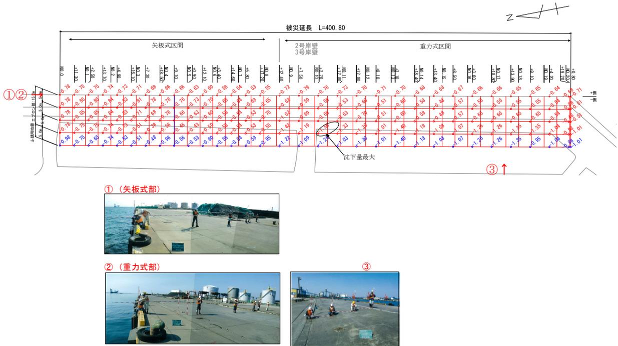
図-3.14.72 No.9 4号ふ頭地区\_-10m岸壁沈下量,被災状況図
