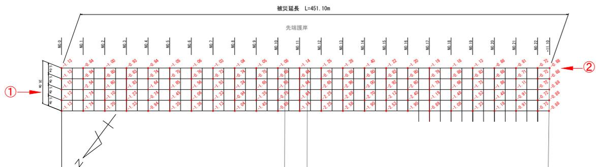
図-3.14.25 No.5 5・6号ふ頭地区先端護岸沈下状況図
