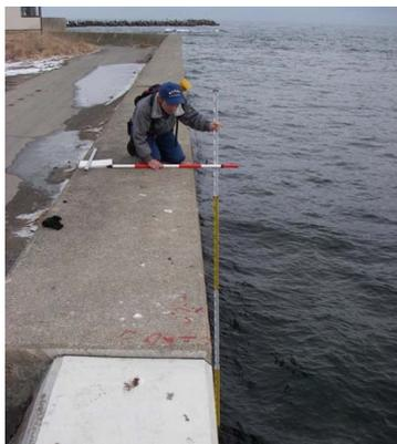
写真-3.2.12 護岸のパラペットの天端高さの測定
