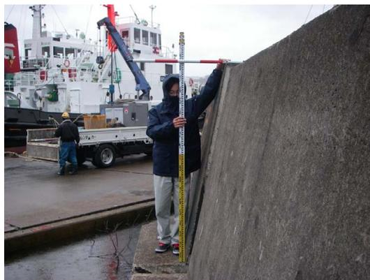
(4) 法線と直角する方向のずれ (約0.05m)
