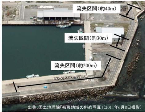
図-3.2.5 護岸のパラペットの流失区間
