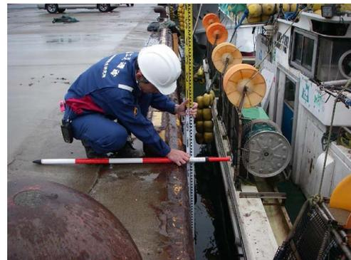
(2) 岸壁の天端高さの測定
