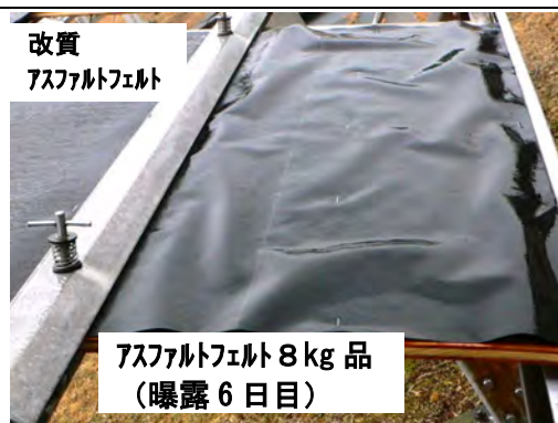
写真-3 屋外曝露比較試験 雨が降った直後に波打つ 8kg 品 (傾斜 60 度)
