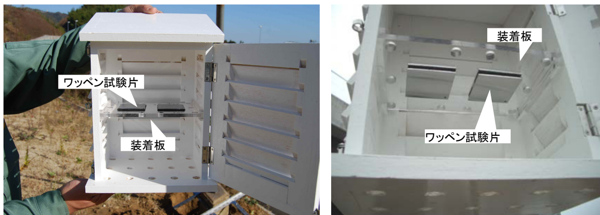
図 3. 2. 8 小型百葉箱内部での試験片設置状況
