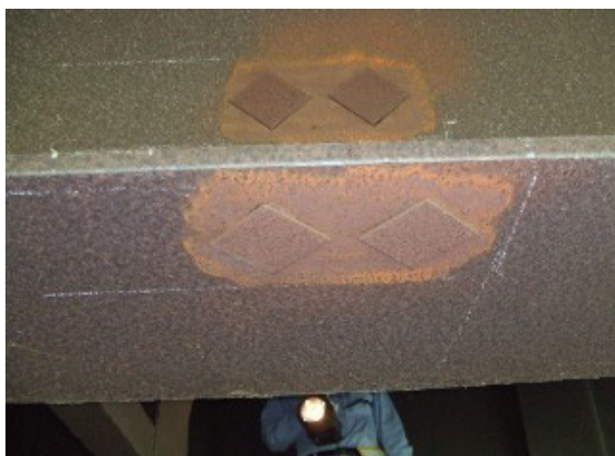
c) 試験片の中間調査時の状況(中桁下面) d) 試験片の中間調査時の状況(外桁西側ウェブ)
