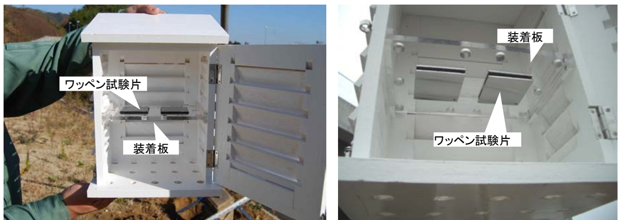
図 3. 2. 8 小型百葉箱内部での試験片設置状況
