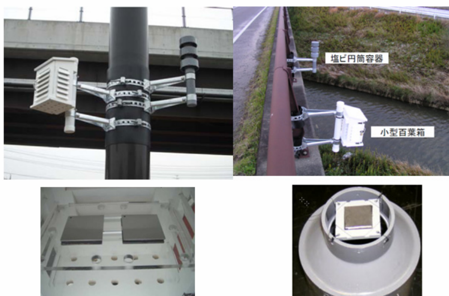
図 2.3.7 ワッペン試験片用小型暴露容器の例（木製小型百葉箱および塩ビ製円筒型暴露容器）
