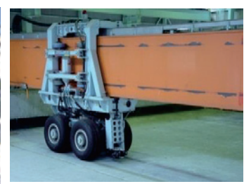
航空機荷重載荷装置
