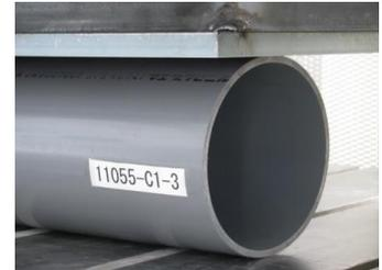
写真1 扁平試験状態
