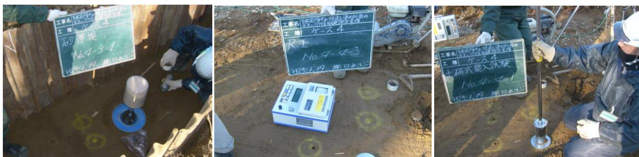
(a) 砂置換法に用いる試験器
