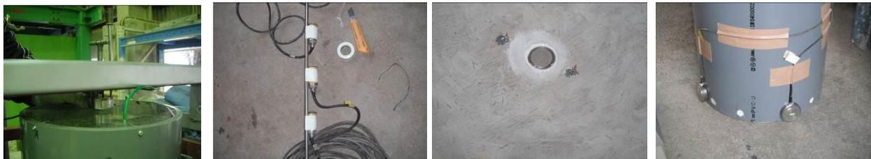
ロードセル (L1) 間隙水圧計 (P1~P6) 底部間隙水圧計 (P7) 土圧計 (S1~S3)
