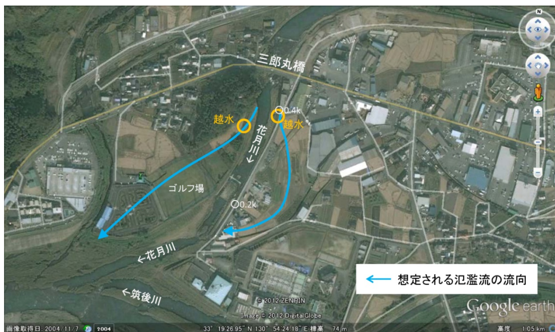
図-3.1.6 筑後川合流点～三郎丸橋付近における氾濫流の状況
