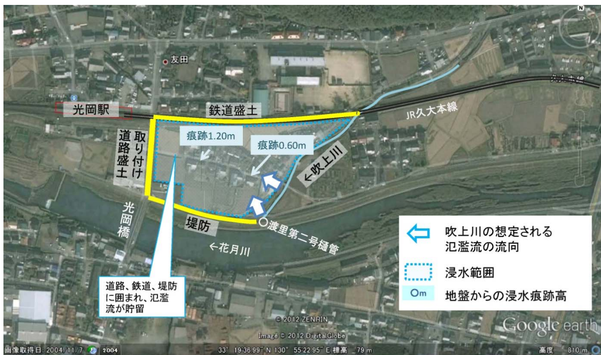
図-3.1.7 光岡橋～吹上川合流点（花月川右岸 1.9k～2.1k）における氾濫流の状況
