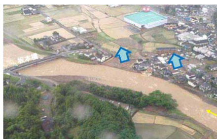
写真-3.1.14 右岸 6.1k 付近の堤防決壊状況 8)
