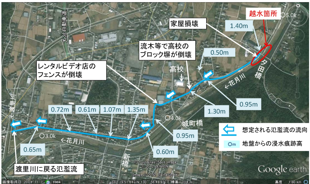
図-3.1.8 渡里川合流点～夕田橋下流（花月川右岸 2.8k～4.7k）における氾濫流の状況
