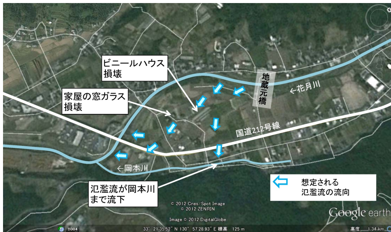
図-3.1.11 岡本橋上流～地蔵元橋（花月川左岸 7.7k～8.1k）における氾濫流の状況
