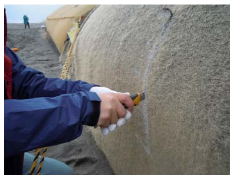
(b) 損傷拡大抵抗性試験：縦と横に 50cm 切
