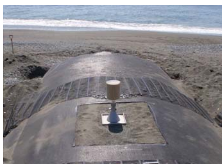
(a) 砂置換法による密度試験
