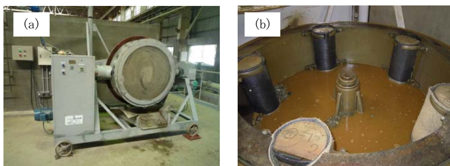
図Ⅱ-4.3.1 回転ドラム型摩耗試験機(a)および供試体の設置状況(b)
