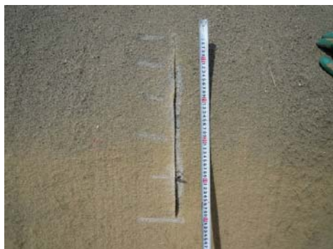
(c) 損傷拡大抵抗性試験（縦）：20hr 後拡大
