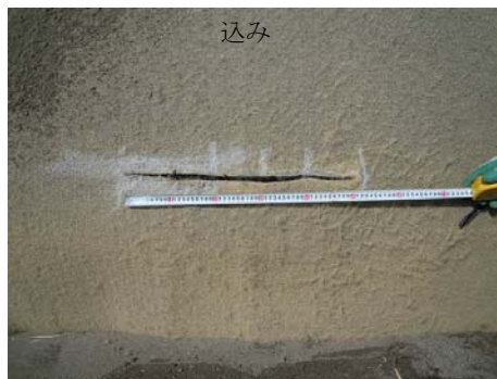
(d) 損傷拡大抵抗性試験（横）：20hr 後拡大
