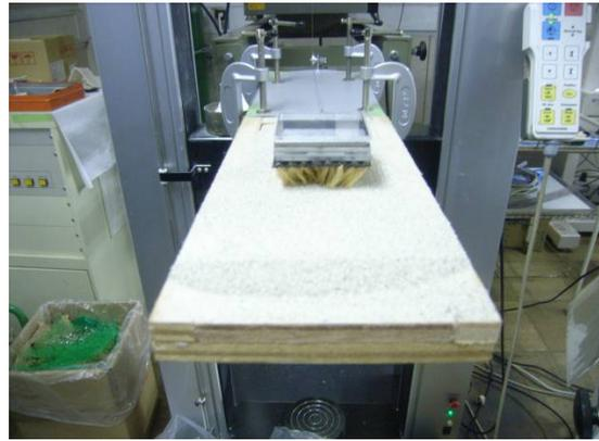
写真II-3.15.2 試験状況（袋材×砂）
