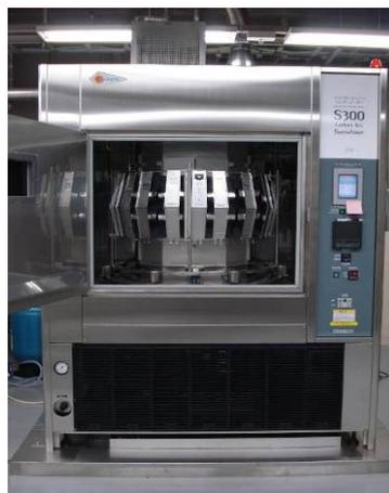
写真Ⅱ-3.6.1 サンシャインカーボンアークランプ式耐候性試験機
