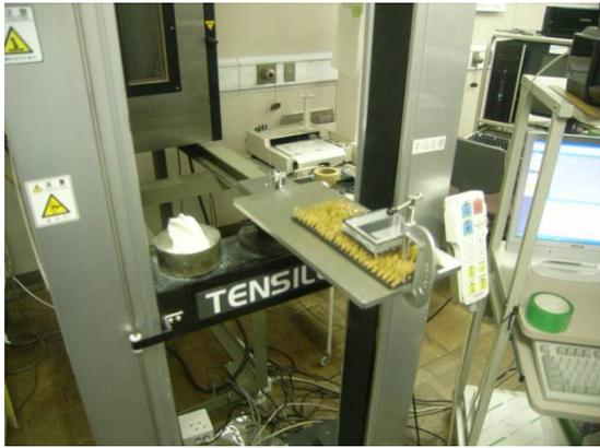
写真II-3.15.1 試験状況（袋材×袋材）
