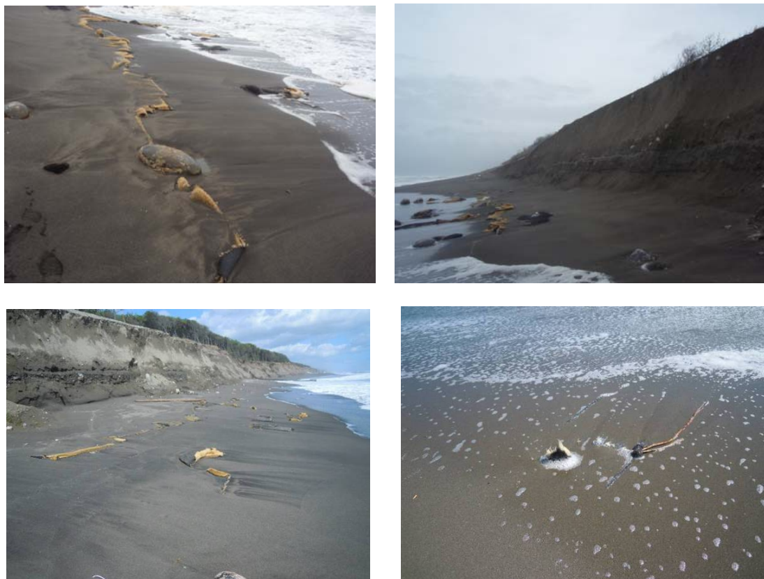
写真 I-4.9.6 取り残しサンドバック袋材の露出状況
