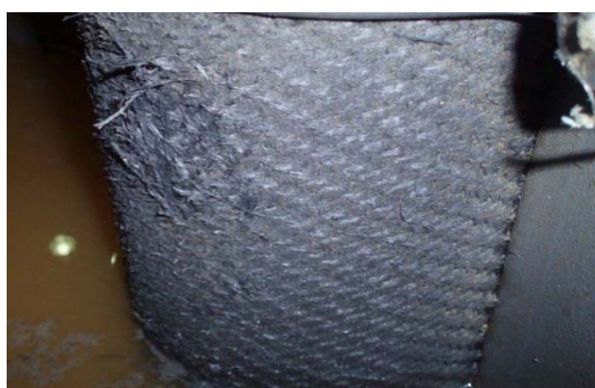
(a) 破断する可能性のある状態 (摩耗促進試験 60,000 回転)
