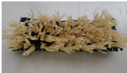
写真 I-4.8.1(2) 劣化促進試験 7,500 時間後 (強度保持率:軸方向 55% 周方向 54%)
