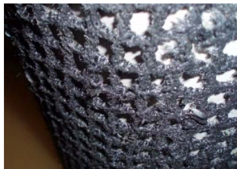
(a) 破断する可能性のある状態 (摩耗促進試験 70,000 回転)
