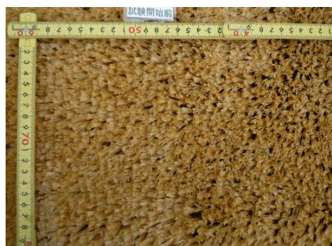
図 I-4.8.5 (2) 養浜盛土が失われ袋材が露出した状態 健全度C
