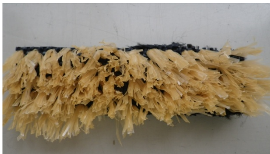
写真 I-4.8.1(1) 気象要因劣化促進試験前
