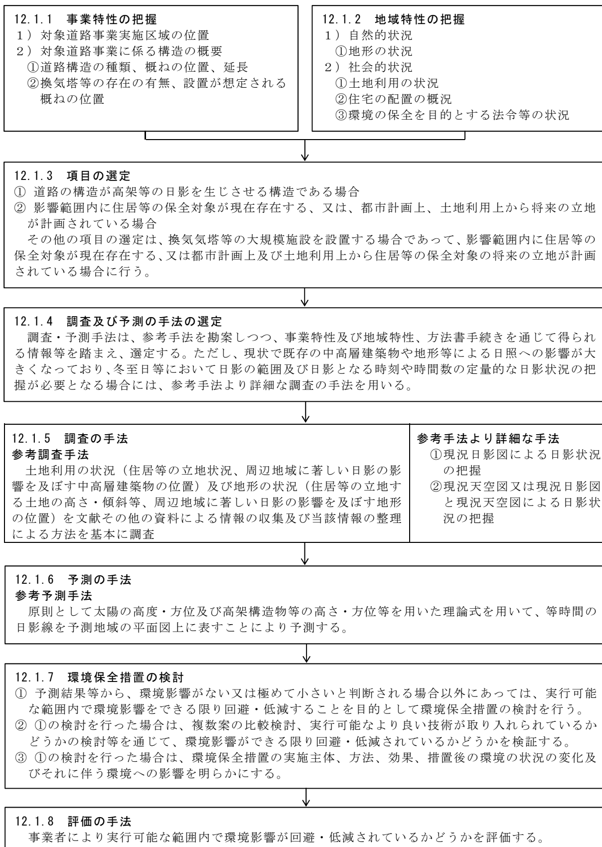
図-12.1 「道路（嵩上式）の存在に係る日照阻害」における調査、予測及び評価の流れ
