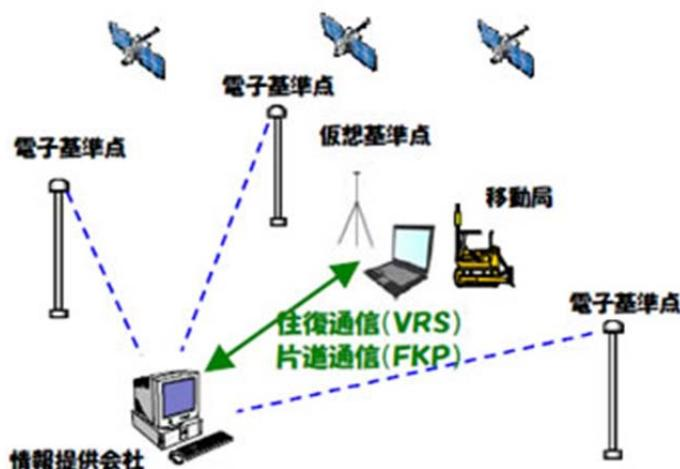
図22-3-8 ネットワーク型 RTK 方式概念図
