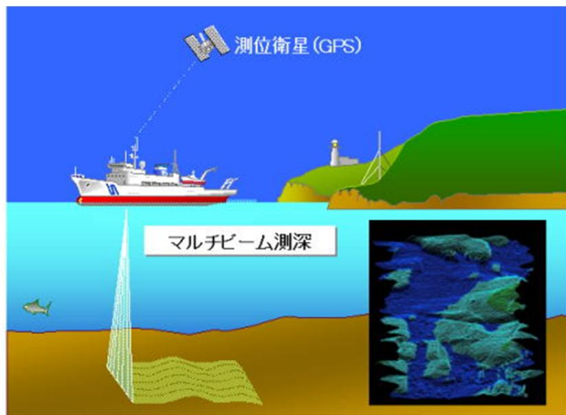
図22-3-1 マルチビーム音響測深のイメージ
