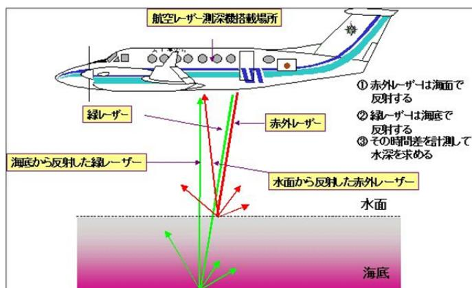
図22-3-4 レーザー測深のイメージ
