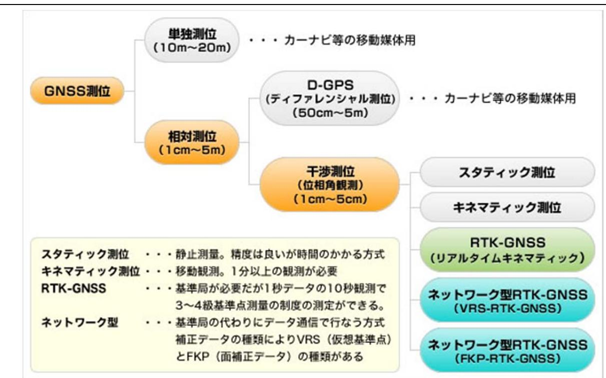
図22-3-6 GNSS測量/計測の方式の種類
