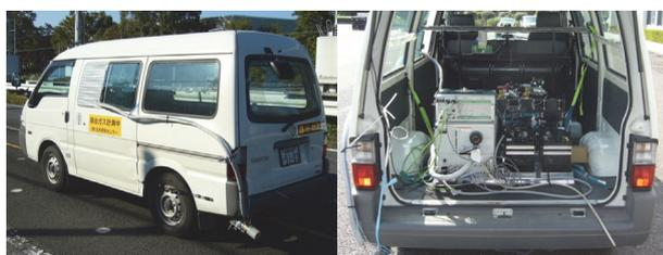
図-1 車載型排出ガス計測システム搭載状況
