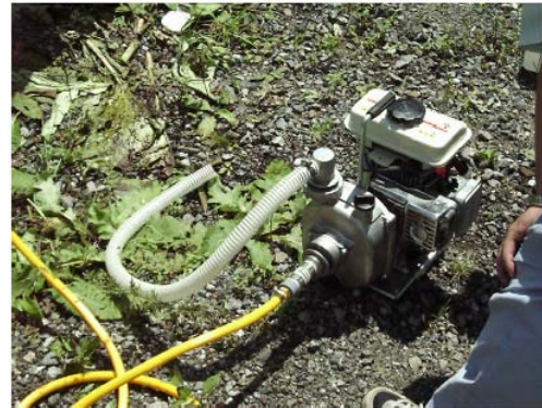
図2 自吸式ポンプのイメージと写真
