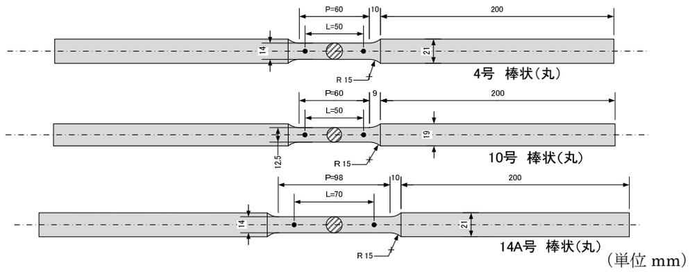
図 1-1 試験片形状の詳細（円形断面）（国総研）
