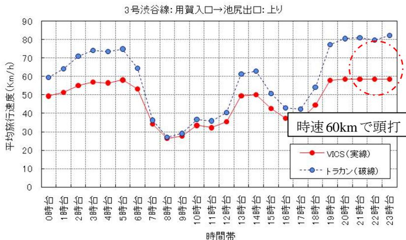
図 2.4-22 時間帯別平均旅行速度の比較 (3号渋谷線上り)
