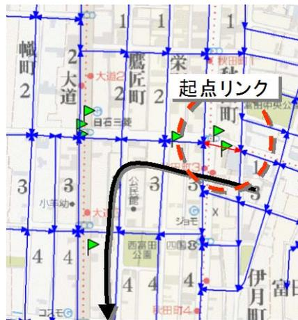
図 2.3-26 位置データとネットワークの読み込み
