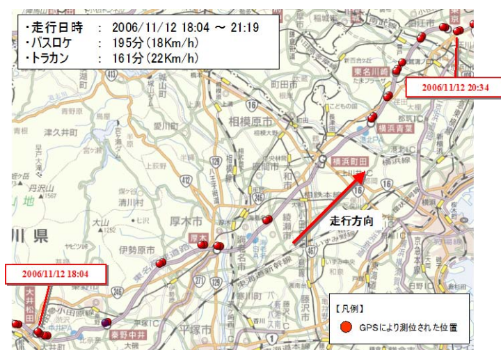
図 2.4-40 旅行時間差の発生状況の確認 (サンプル 4)
