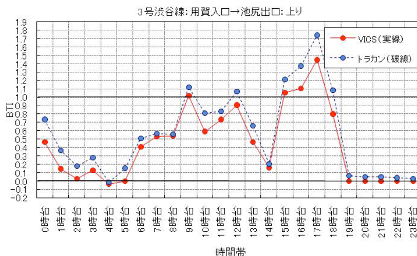
図 2. 4-24 時間帯別 Buffer Time Index の比較（3 号渋谷線上り）
