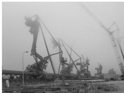
写真-4 アンローダーの倒壊（相馬港）
