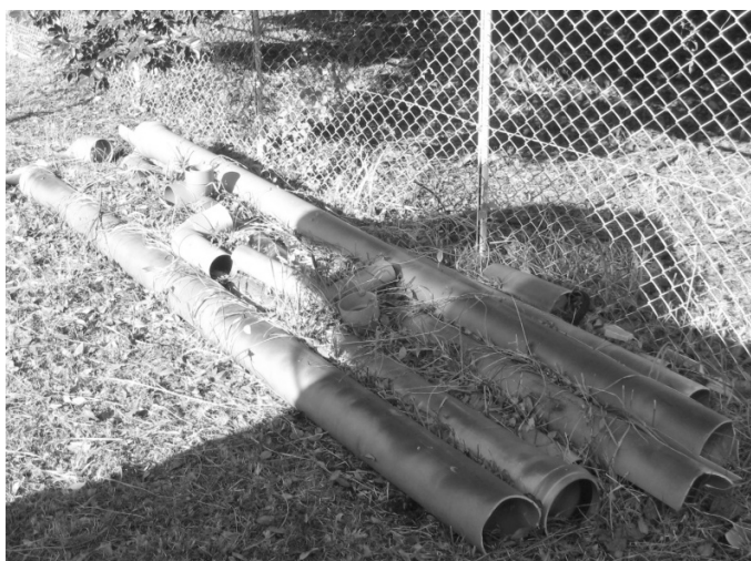
写真－２ 露出管（約 15 年間屋外曝露）
