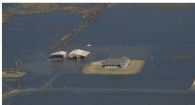
図-27 FEMA-HMGP に基づく住宅の機能強化 (土地の嵩上げ) によって浸水を免れた例
