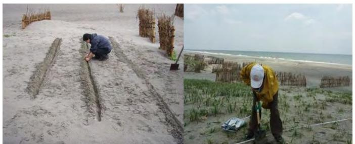
「砂浜再生プロジェクト」で取り組んで 砂中温度測定のため、20—40cmの食性による砂丘の安定化を目指して60cmと深度を変えてデータロガーを設置。
