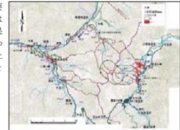
図-3 降灰後の土石流シミュレーション結果
