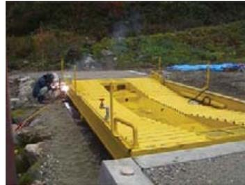
写真-1 タイヤ洗浄装置
