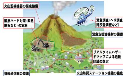
図-1 火山噴火緊急減災対策砂防イメージ
