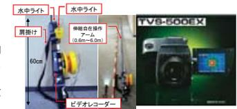
図4 水中カメラ（左）と熱赤外線カメラ（右）
