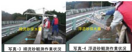
写真-3 掃流砂観測作業状況
