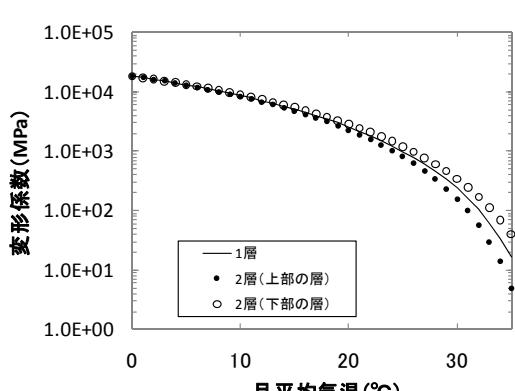
図-6 混合物層の層数による変形係数の違い
