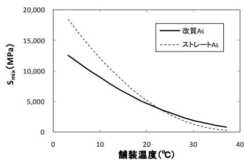
図-2 改質アスファルト混合物の変形係数
