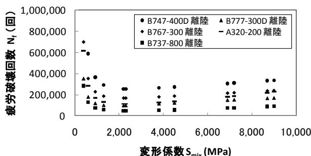
図-36 変形係数  $S_{mix}$  と疲労破壊回数  $N_f$  の関係
