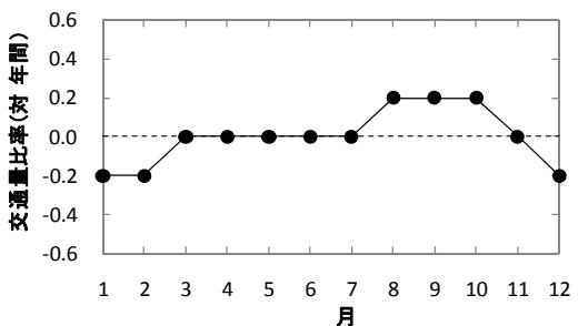
図-34 交通量の季節変動（検討モデル）
