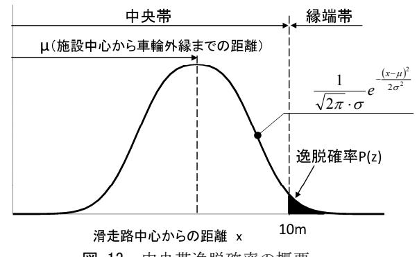
図-13 中央帶逸脱確率の概要
