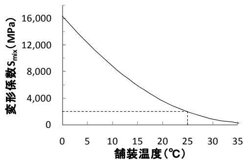
図-37 舗装温度と変形係数  $S_{mix}$  の関係
