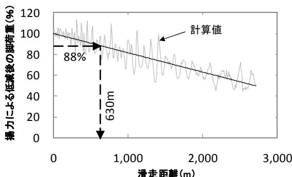
図-22 滑走路距離による主脚荷重の低減結果
