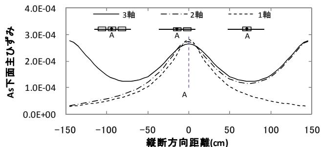
図-28 輪荷重を同一とした場合の As 下面ひずみ
