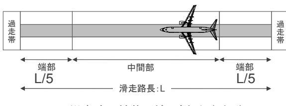
(a) 滑走路の舗装区域の概要(平面)
