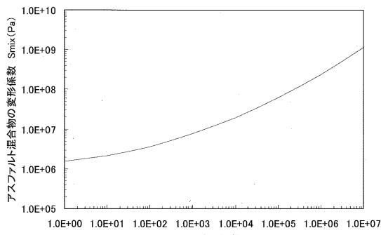
図-1  $S_{bit}$ - $S_{mix}$  クリープ曲線<sup>8)</sup>
