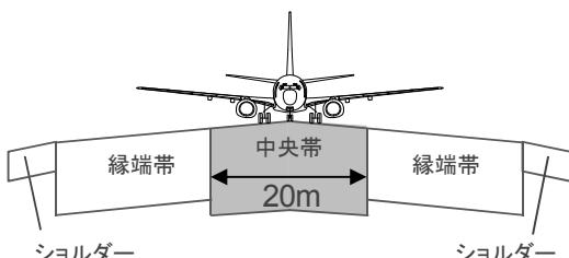
(b) 滑走路の舗装区域の概要(断面)
