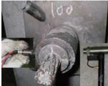
写真 4.3.7 CASE E-3（片側の定着コーン側面の受発信状況）
