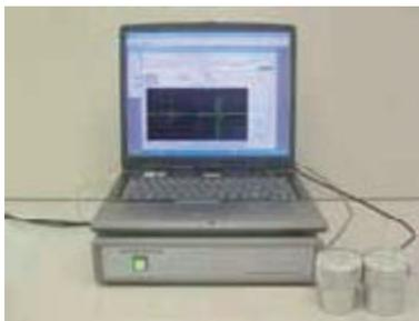
写真 4.3.9 超音波法計測機器
