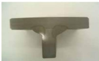
写真-1-1 マクロ試験結果（直ウェブ）
