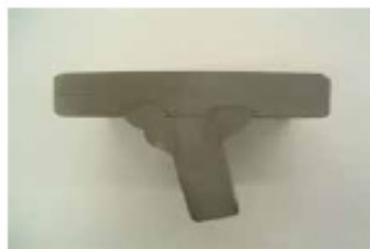
写真-1-2 マクロ試験結果（斜めウェブ）
