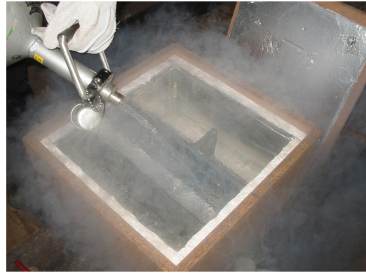
写真-2.2.9 切断状況④（液体窒素による冷却）
