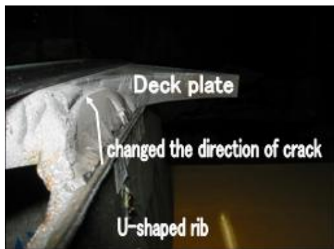
写真-2.3.2 実験終了後の破面
