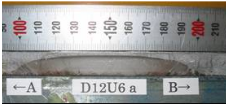
写真-2.3.1 破壊後の破面の例
