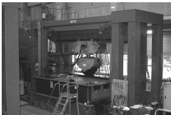
写真-4.3.1 輪荷重走行試験状況
