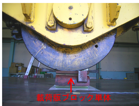
写真-3.2.2 載荷版ブロックごとでの静的多点載荷
