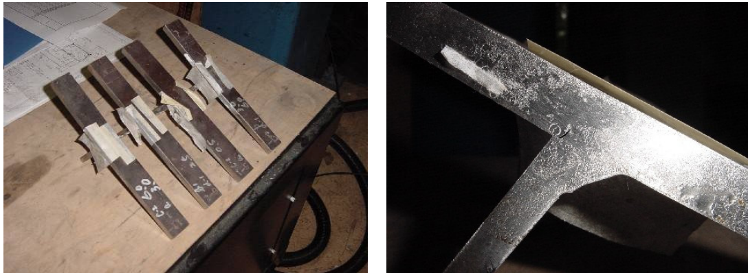
写真-4.3.4 超音波探傷試験の精度確認に用いた小型供試体の例
