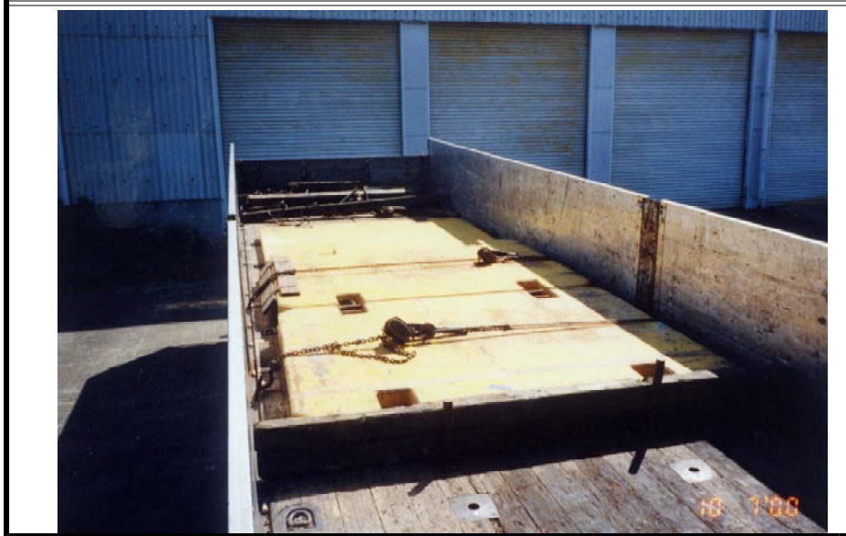
大型試験車の加重板搭載状況(10t)
