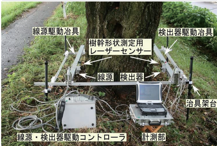
▲ γ線樹木腐朽診断器の測定状況
