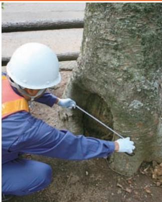
③開孔空洞（左：芯に達する、右：芯に達しない）
