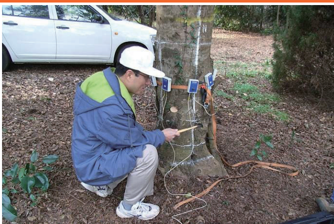
▲弾性波速度測定機（PICUS）の測定の様子
