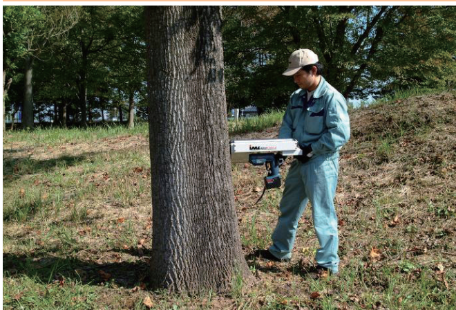
▲貫入抵抗値測定機（レジストグラフ）の測定の様子
