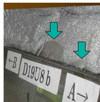
写真 3.2.4 き裂の断面図
