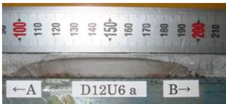
写真 3.2.1 破壊後の破面の例
