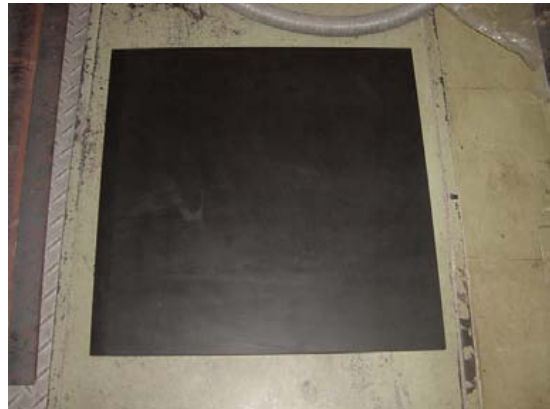
写真 3.1.4 クロロプレンゴム全景 (ゴム購入時 500mm×15mm×500mm)
