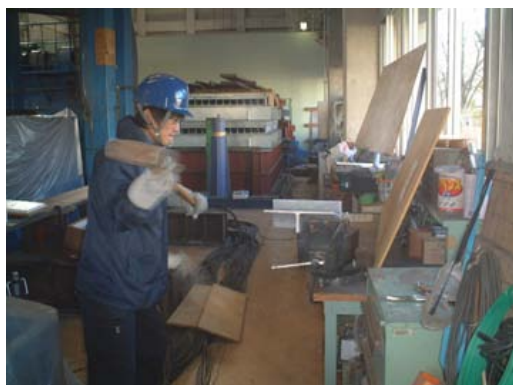
写真 3.1.10 低温脆性破壊状況（液体窒素挿入 1 供試体当たり 10L 程度）
