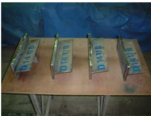
写真 3.1.8 切断状況①切断終了試験片
