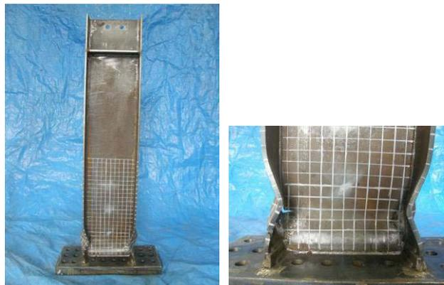
写真 1 梁試験体最終変形状態の例
