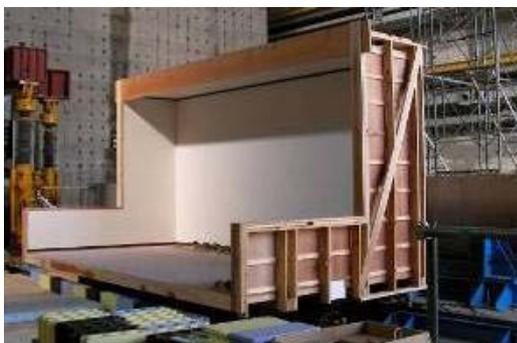
写真 2 什器等の応答を検討したモデル
