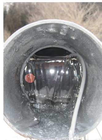
写真－2 堰部の流水状況(ケース 4)
