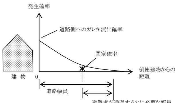
図-4.7 ガレキ流出、閉塞確率等の関係のイメージ
