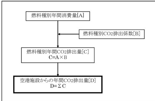
図-3 空港施設からの二酸化炭素排出量算定フロー
