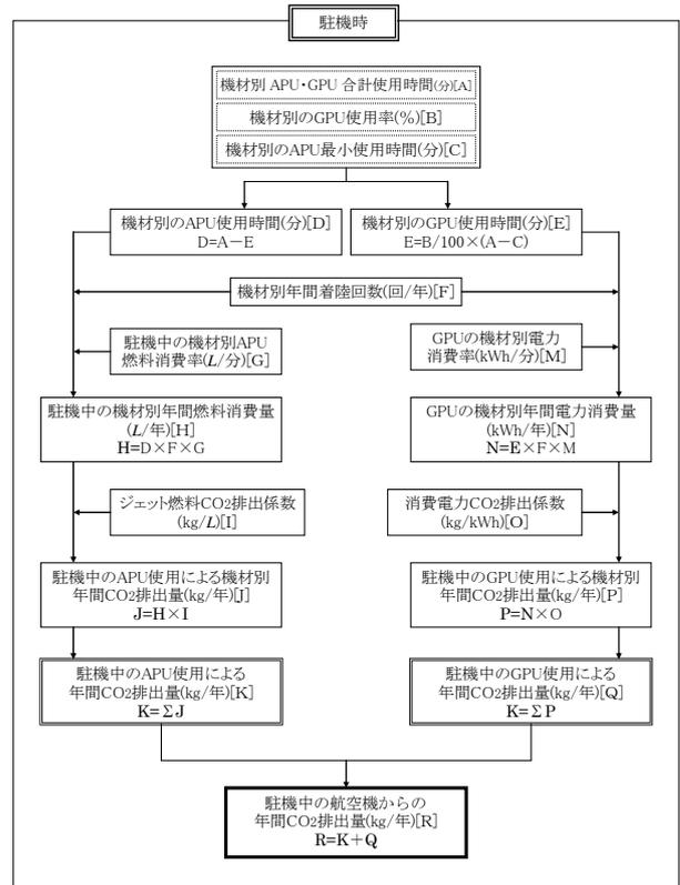
図-4 航空機（駐機時）からの二酸化炭素排出量算定フロー
