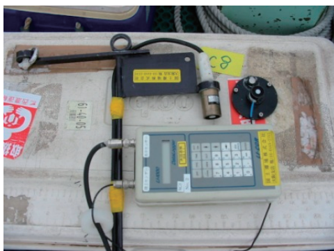
写真 5.4-5 光量子計（左）と光量子の測定状況（右）
