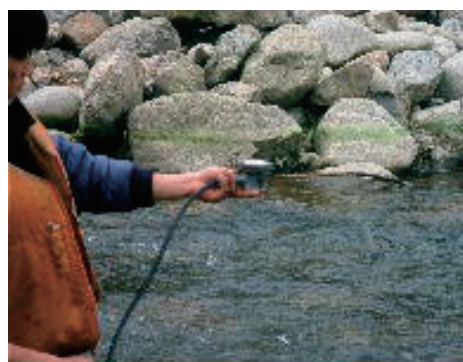
写真 5.4-5 光量子計（左）と光量子の測定状況（右）
