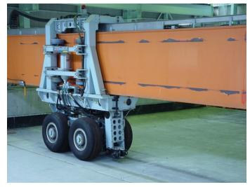
航空機荷重載荷装置
