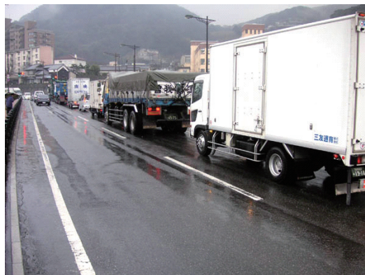
写真解 4.3-2 橋梁の前方に交差点がある場合の第二車線への大型車の集中例
