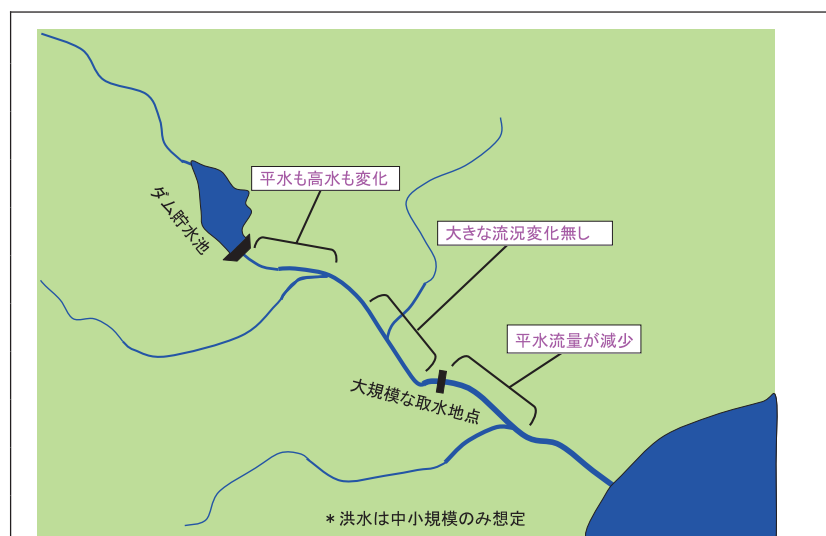
図-6 ダム貯水池の下流河川における流況の縦断変化パターンの代表例。7.2 に示している事例もあわせて参照されたい。ダム直下流においてはダムによる流況調整や発電のためのバイパスの影響が支配的であるが、下っていくとダムのない残流域の影響が加わり、発電用水も河川に戻ってくるため、流況の人為調整の影響が薄まっていく。さらに下流に行くと、今度は河川からの取水という直接的な要因で平水流量の有意な減少が起こってくる。なお、災害を引き起こすような規模の大きな洪水に対しては、下流における所定の地点で所定の洪水流量調節が図られるようダム操作が行われる。
