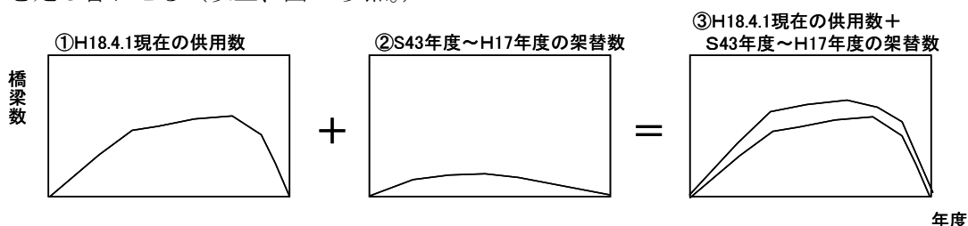
図-2 橋梁架設数の計算手順（その1）
