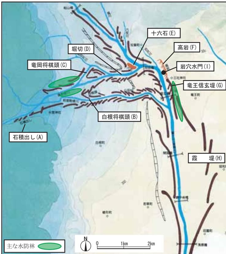
■釜無川・御勂使川における信玄堤システムの概要図(出典1-4)
