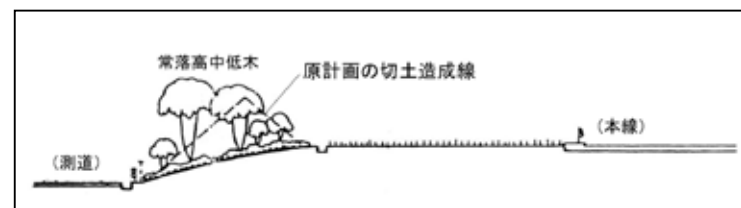
地形が小山状に残る切土法面の切飛ばし造成
