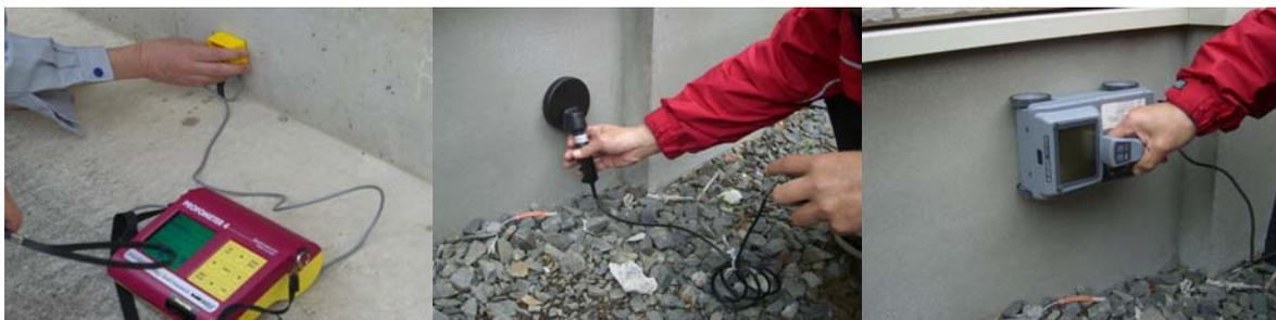
写真-8.9 鉄筋計による基礎コンクリートの配筋等の調査
