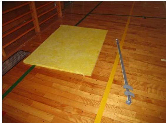
写真-7.6 脱落したグラスウールボードとバー材
