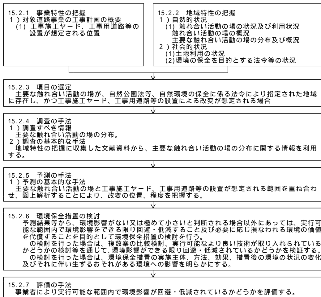
図-15.4 工事施工ヤード、工事中用道路等の設置に係る触れ合い活動の場の環境影響評価における調査、予測及び評価の流れ
