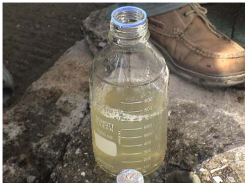
写真-5 腐敗槽の上澄水(事務所)
